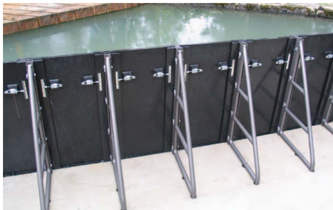
Fig. 3 Struttura sperimentale dell'Oskar-von-Miller-Institut presso l'Università Tecnica di Monaco: le lastre di protezione contro l'acqua alta risultano resistenti e ad elevata tenuta.
