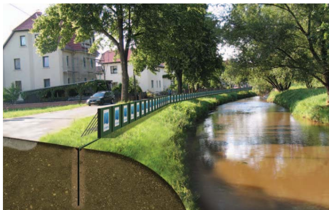
Fig. 4 Lastre di protezione delle acque sotterranee di Noah: una protezione efficace ed ecologicamente sostenibile contro il problema dell'acqua alluvionale nelle acque sotterranee". (Foto: Noah)
