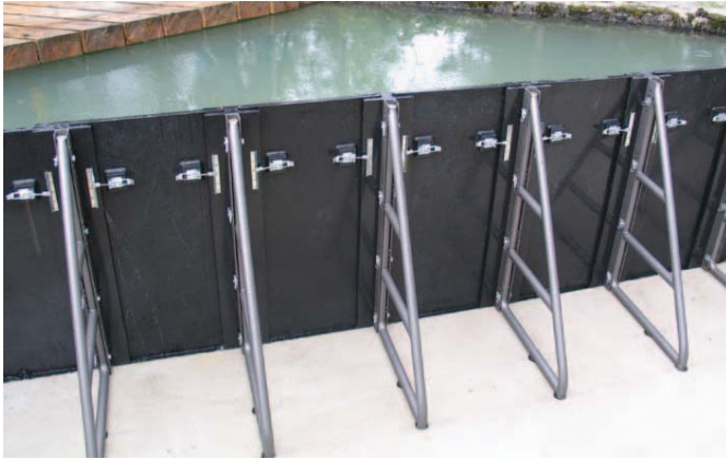
Obrázek 3. Experiment Ústavu Oskara von Millera Technické univerzity v Mnichově protipovodňové desky prokazují svou stabilitu a nepropustnost
