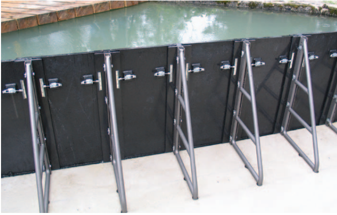
Bild 3. Versuchsaufbau des Oskar-von-Miller-Instituts an der Technischen Universität München – die Hochwasserschutzplatten erweisen sich als standfest und dicht
