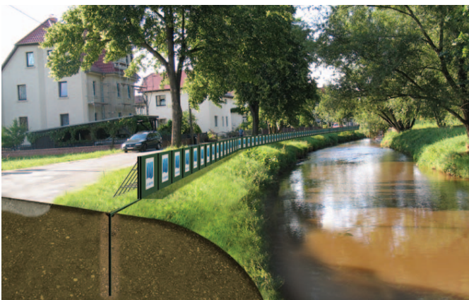
Bild 4. Grundwasserschutzplatten von Noah: effizienter und umweltschonender Schutz gegen „Hochwasser im Grundwasser“ (Bilder: Noah)
